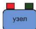
Рисунок 2 — Символ, используемый для обозначения узла с его точками выхода и входа сервиса
