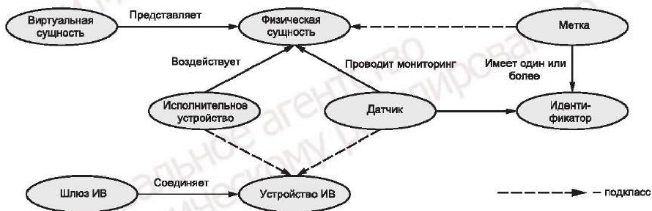
Рисунок D.4 — Виртуальный объект, физический объект и устройство ИВ
