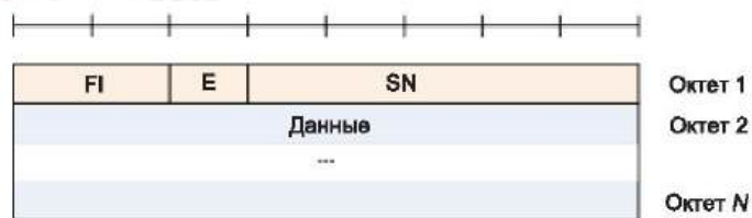
Рисунок 22 — RLC PDU для объекта UM RLC с фиксированной частью заголовка UMD PDU
