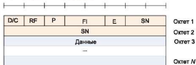
Рисунок 23 — RLC PDU для объекта AM RLC с фиксированной частью заголовка AMD PDU
