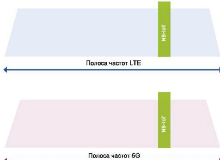
Рисунок 30 — Размещение канала NB-IoT в полосе частот LTE и 5G
