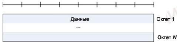
Рисунок 21 — RLC PDU для объекта TM RLC
