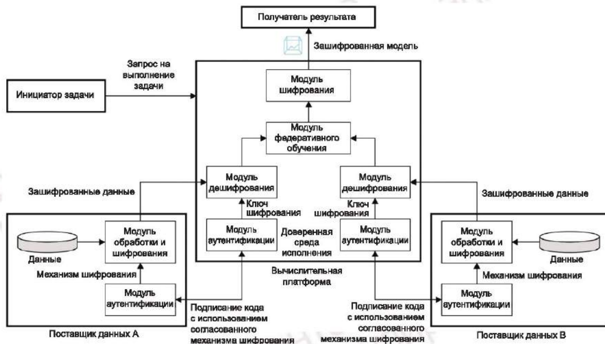
Рисунок 2 — Техническая архитектура федеративной системы МО в централизованном режиме
