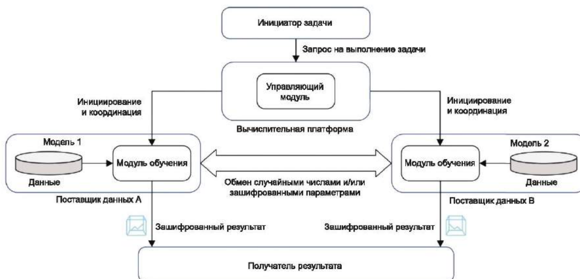
Рисунок 4 — Техническая архитектура федеративной системы МО в децентрализованном режиме
