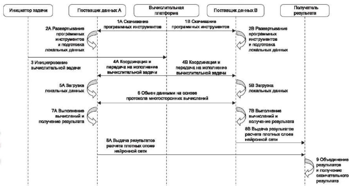
Рисунок 5 — Процедуры обработки федеративной системы МО в децентрализованном режиме
