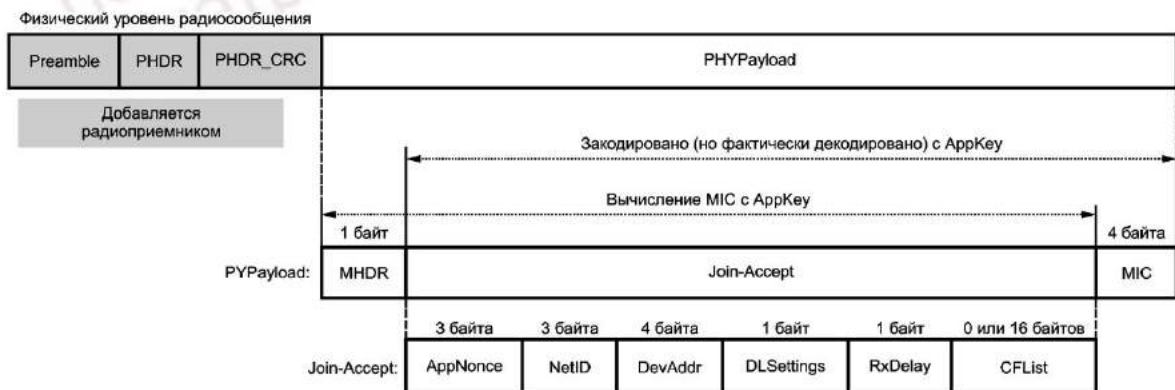
Рисунок 6 — Структура нисходящего радиосообщения с подтверждением о присоединении к сети
