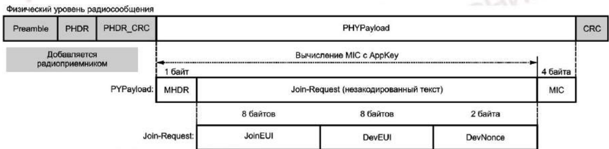
Рисунок 5 — Структура восходящего радиосообщения с запросом на присоединение к сети
