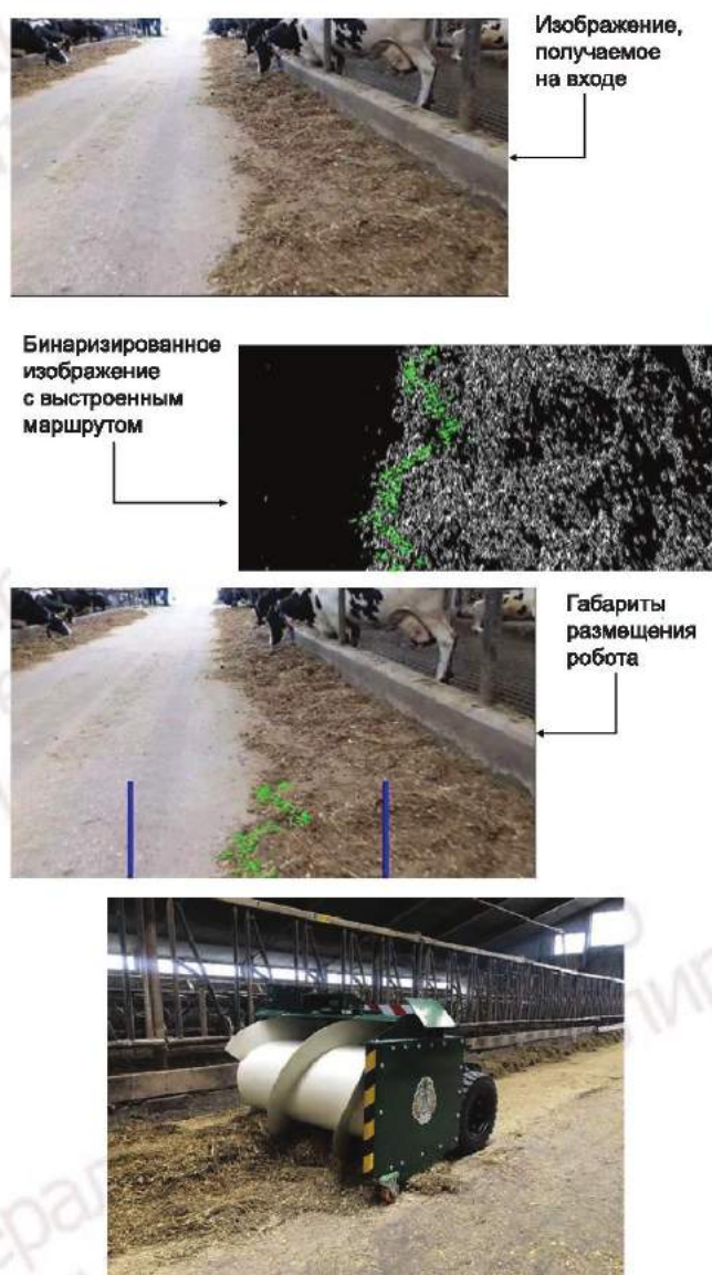
Рисунок В.1 — Алгоритм работы колесного робота обслуживания кормового стола
