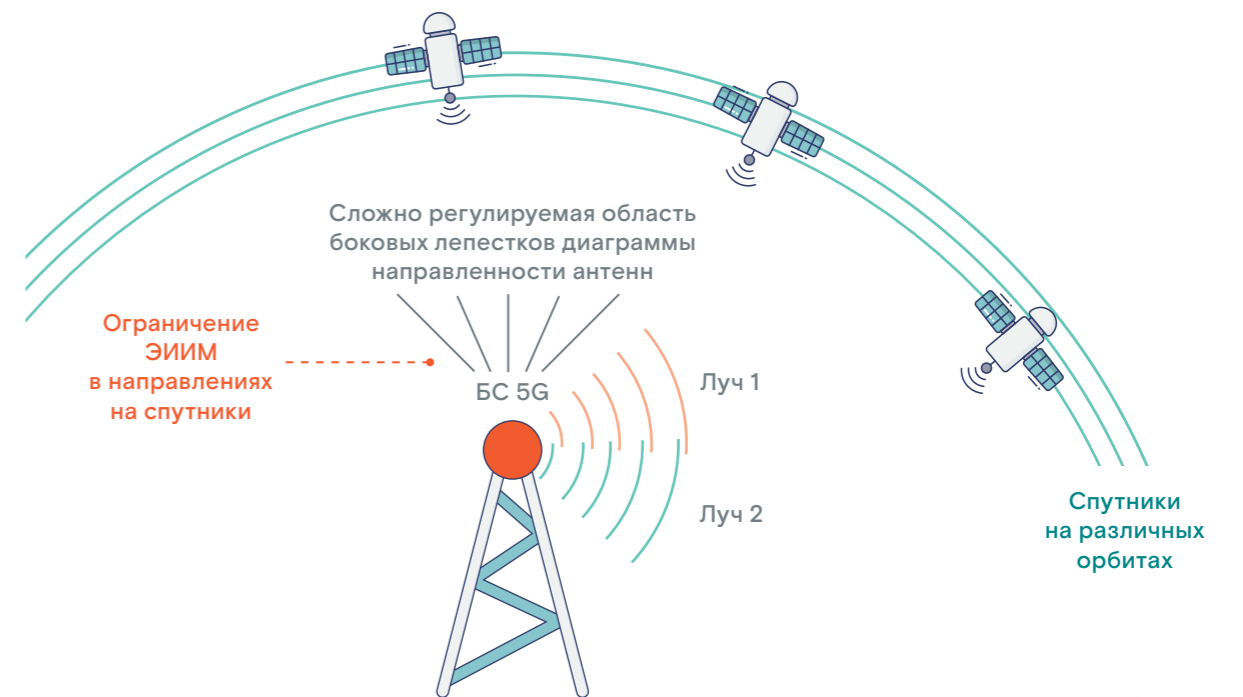
Рис. 11. Иллюстрация требований к ограничению мощности излучения базовых станций в полосе радиочастот 26,1–26,9 ГГц
