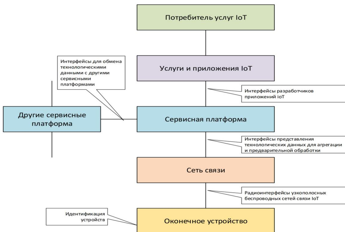
Рисунок 12. Предлагаемая типовая архитектура узкополосных беспроводных сетей связи IoT
